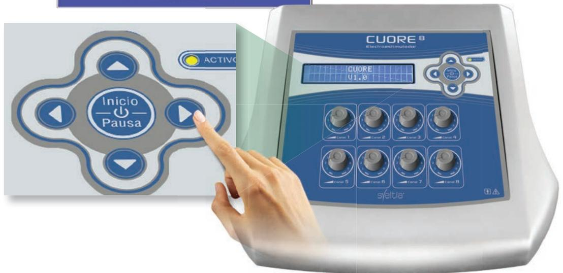
Luego se puede optar por el modo a utilizar con las flechas hacia arriba o hacia abajo. Una vez elegido el modo, se oprime la flecha hacia la derecha o botón de avanzar.
