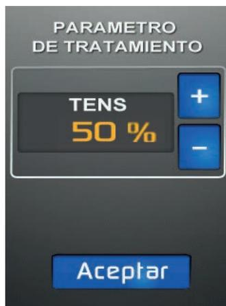
• Los parámetros de ondas T.E.N.S se modifican presionando el botón **TENS** y aparecerá la pantalla correspondiente con los parámetros ajustables.
