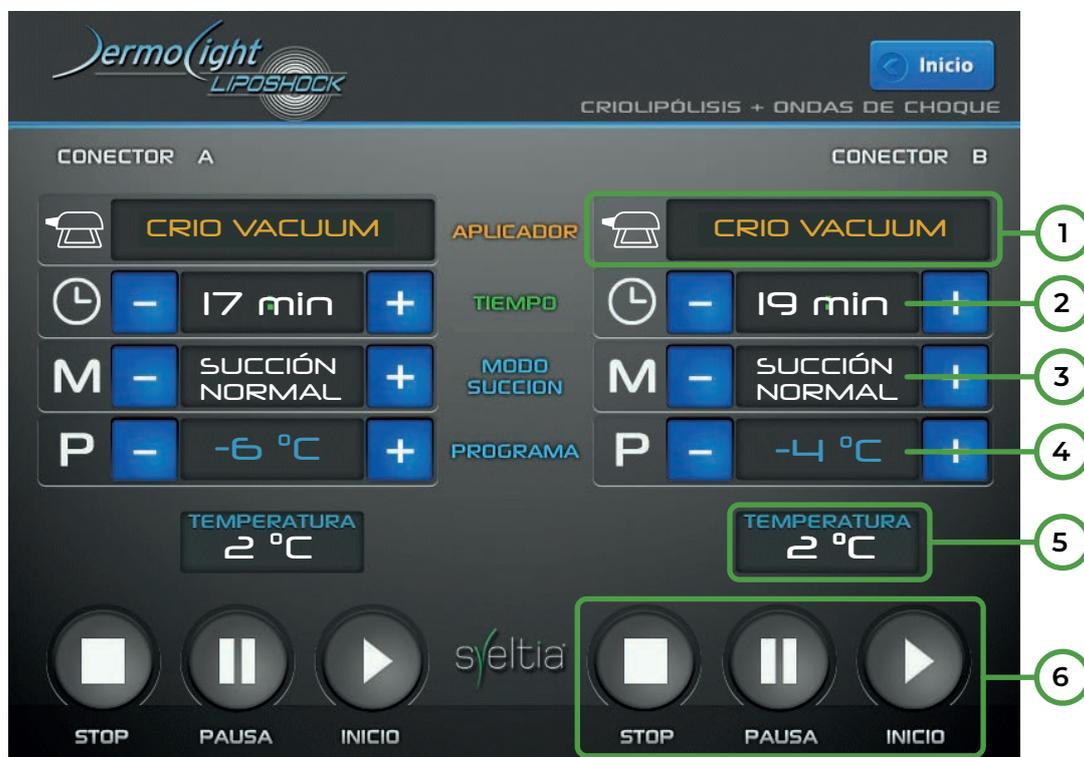
1. Indicador de aplicador. El cabezal es detectado automáticamente y la pantalla se configura para el mismo. Aparece el nombre y el ícono correspondiente.
