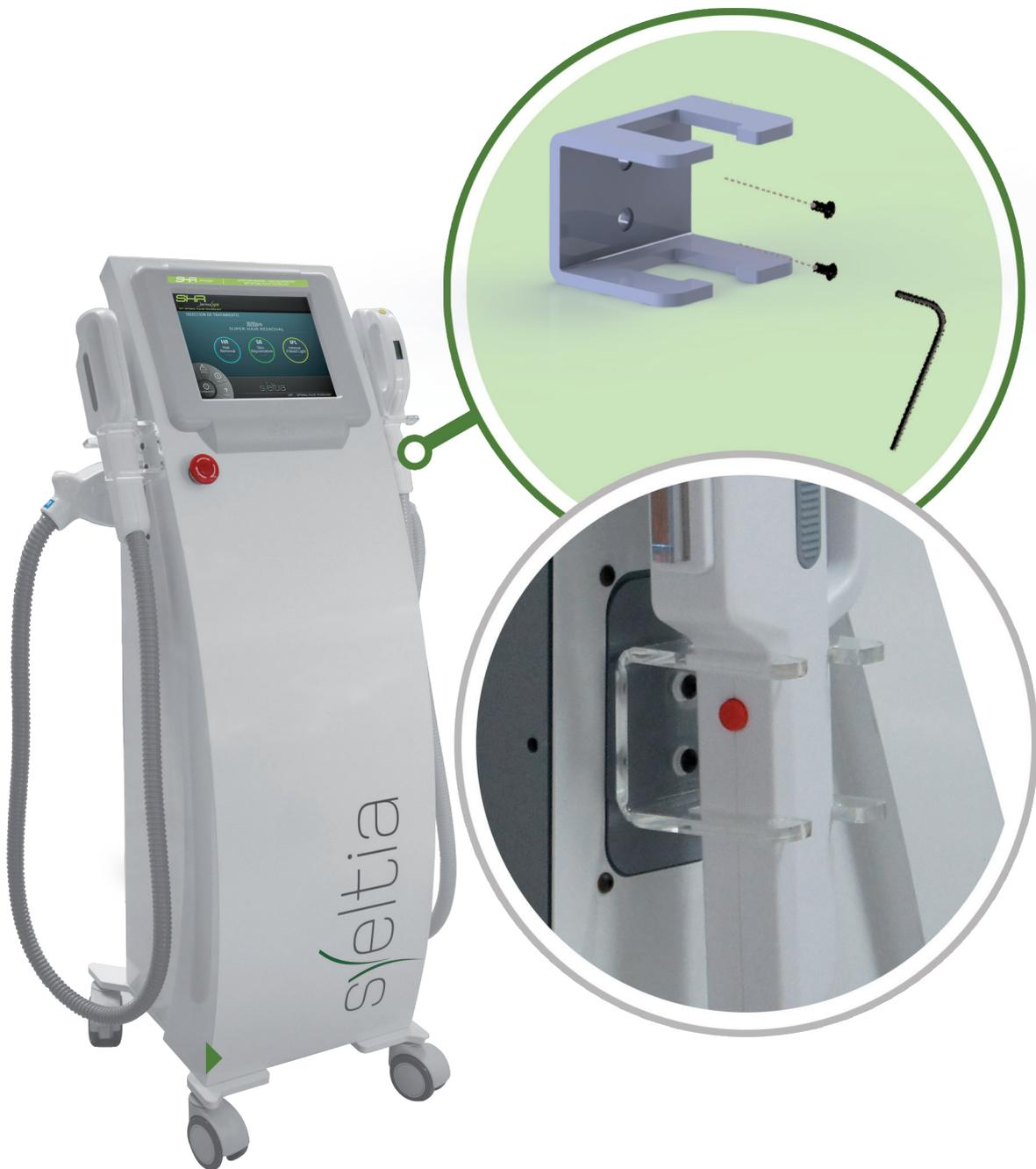
El equipo viene equipado con dos portacabezales de acrílico transparente. Los debe colocar el usuario, en cada lateral del equipo. Para ello se proveen cuatro tornillos y una llave tipo allen. Coloque los portacabezales como indica la figura. No es necesario ajustar demasiado los tornillos.
