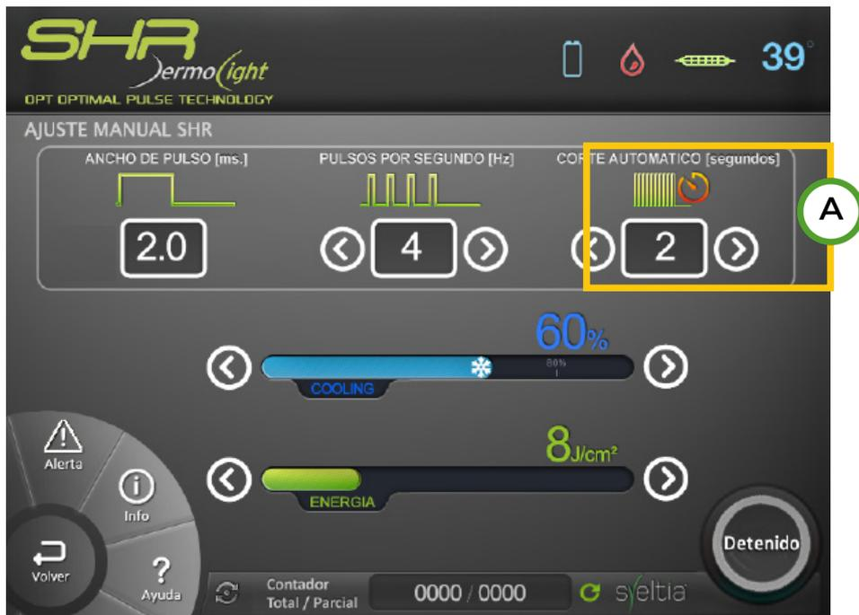
El corte automático de disparos (ref. A) es una medida de seguridad extra que se provee al operador del equipo. De acuerdo al valor fijado (2 segundos en el ejemplo), el cabezal dejará de disparar una vez transcurrido dicho tiempo. Es decir que se interrumpirá el tratamiento hasta que el operador suelte y oprima nuevamente el botón de disparo o pedal, reanudándose la aplicación.
