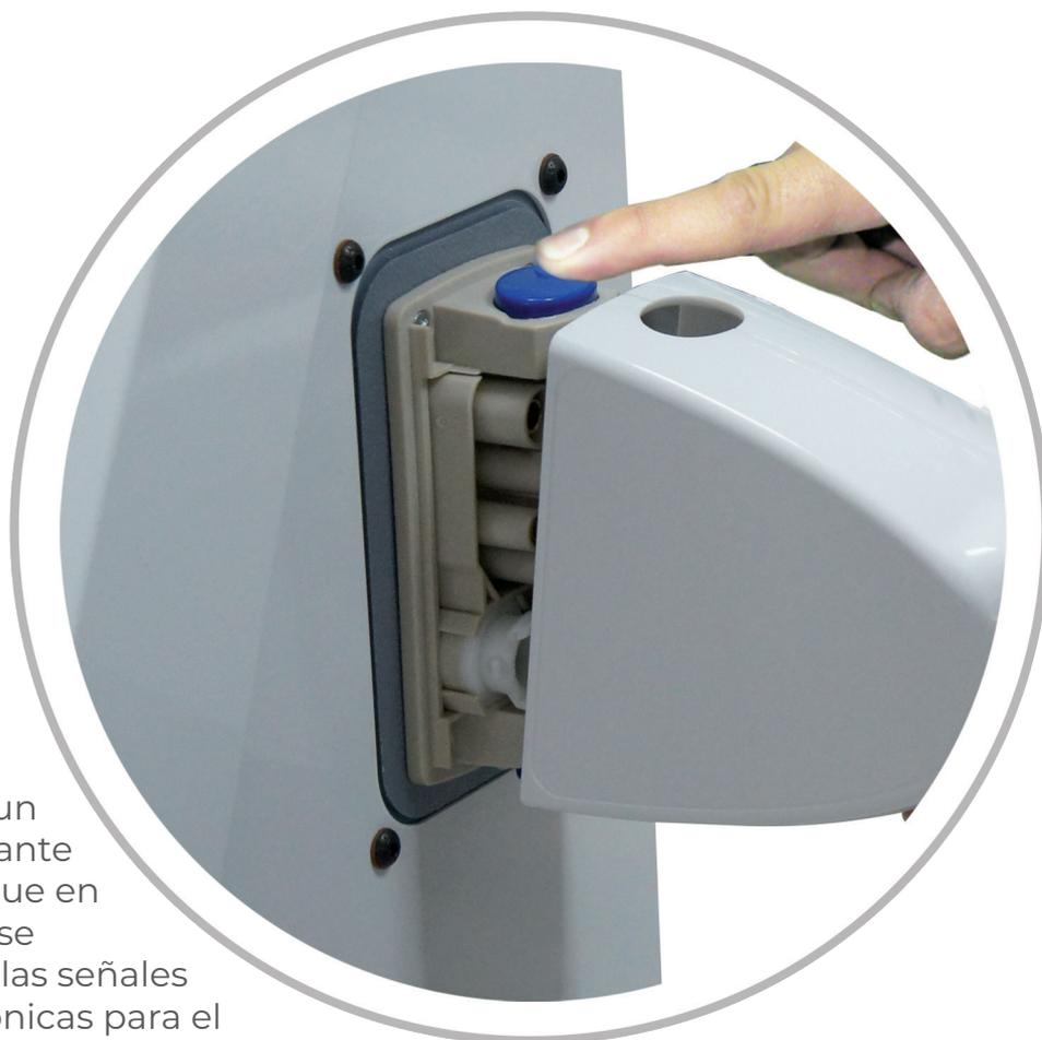
Este conector es un elemento importante de la unidad, ya que en un solo conjunto se transmiten tanto las señales de control electrónicas para el disparo, las tensiones necesarias para el preencendido de la lámpara y disparo (descarga) de la misma, como así también la entrada y salida del agua de refrigeración.
