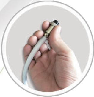
Conectar los cables de los cabezales de RF al equipo.
