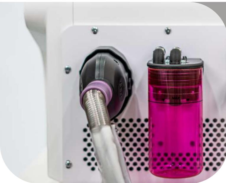
Antes de colocar el depósito del filtro nuevamente verificar que los **sensores de gel** estén libres de residuos y secos, para evitar la activación errónea de la alarma de gel en el equipo.
