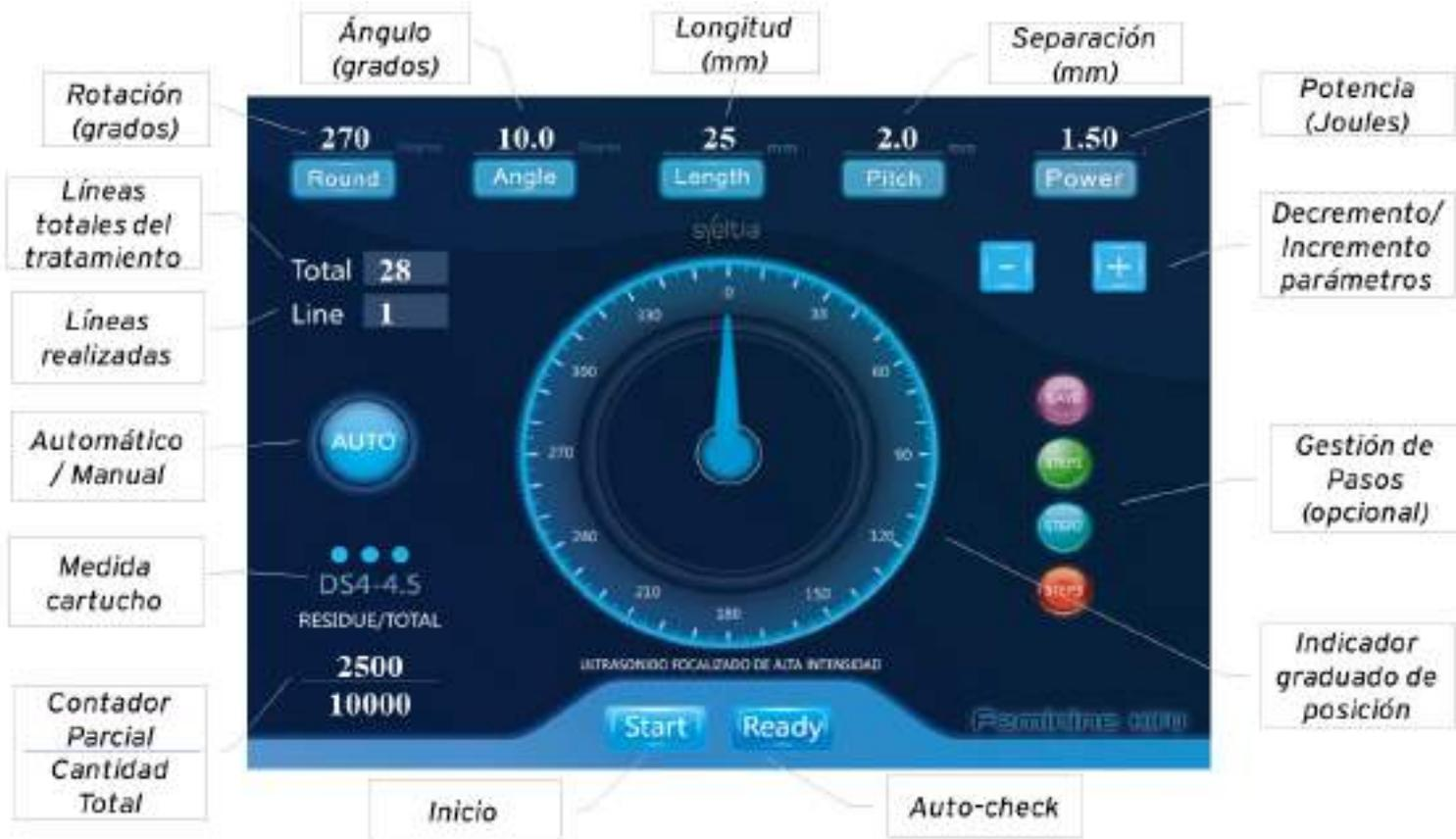
**Ajuste de Parámetros:** Para modificar los valores primero se debe presionar sobre la opción a modificar y con los botones de + y - se puede incrementar y decrementar el valor seleccionado
